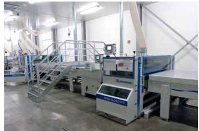
Sparte Fußboden der Tochterfirma Interdomus geht. Fast zwei Jahre beschäftigte sich AV Design intensiv mit dem „Hot Coating“-Verfahren und investierte kräftig in Gebäude und Produktionsmittel. Die 120 m lange Produktionslinie in U-Form nimmt eine eigene Halle ein. In dieser wiederum gibt es eingehauste Bereiche, um eine möglichst staubfreie Umgebung zu gewährleisten.
