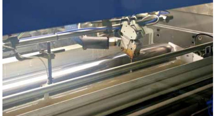
ersten Basecoat übernehmen zwei Walzenauftragsmaschinen. „Die eigentliche Innovation ist, dass der Lack nass in nass aufgetragen wird. Denn der PUR-Kleber ist noch nass, wenn der Lack appliziert wird“, erklärt Betriebsleiter Oliver Seehausen-Engelke. Und damit man diese Parameter fehlerfrei im Griff hat, liefert Kleiberit dafür auch gleich die passenden UV-Lacke. Nach der ersten Lackapplikation folgt eine Station zum Angelieren der Oberfläche, bevor der zweite Basecoat aufgetragen wird. Dann
